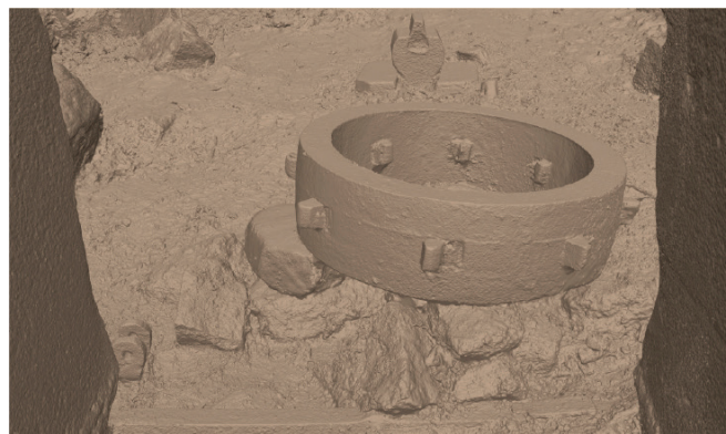
Obr. 24. Detailní pohled na 3D model bez textury. V popředí je patrné palečné kolo s vykreslenými palci a jejich fixačními klínky. V zadní části se nachází kovářina. Autor J. Pařez.
