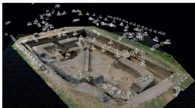
Obr. 2. Systém vícenámkové fotogrammetrie vizualizovaný na příkladu 5. kostela v Mikulčicích. Každý jehlan představuje jednu standardní dokumentační fotografii objektu. Fotografie byly pořízeny ze všech stran a z více úhlů, aby z nich bylo možné spočítat kompletní 3D model základů kostela. Podle Krupičková et al. 2022, 74–75, obr. 33, grafika J. Šindelář.
