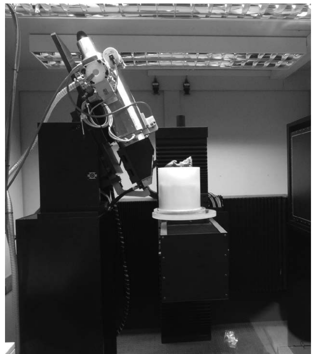
Obr. 4. Průmyslový CT skener DIONDO D3 s vysokým rozlišením, dočasně převezený z Lipska do Dolních Věstonic. Foto J. Svoboda.
